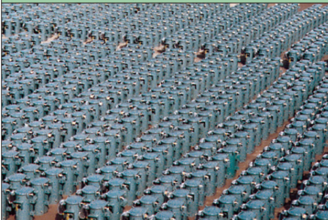
地下式變壓器 Submersible Transformer
